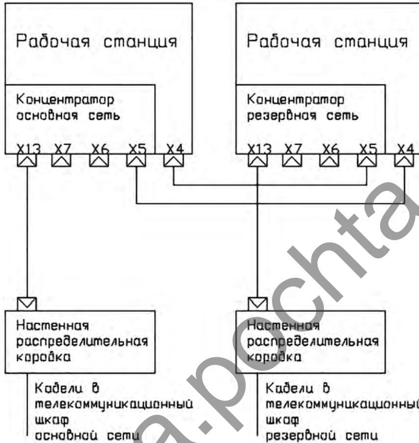
Рис. 2. Схема подключения двух рабочих станций к сети СВБУ
